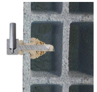
Filtre métallique - vue en coupe
