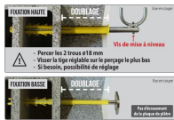
Fixation radiateur fonte - vue en coupe
