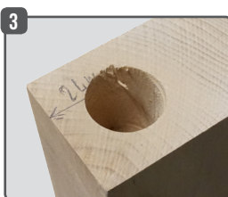
3 Le portail est prêt à recevoir l'équerre.
